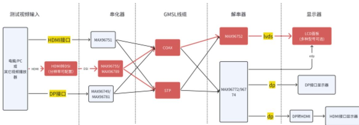
\* HDMI输入转DSI及DSI输入串化[MAX96755/MAX96789]
